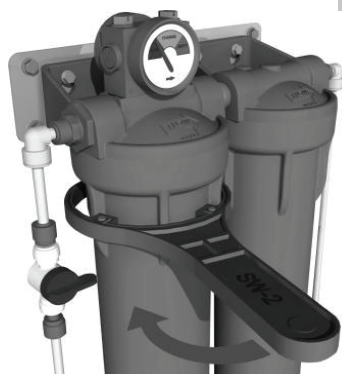
Dévisage de la cuve du filtre
